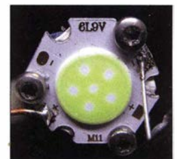
Bild 2: Bei schrägem Lichteinfall sind die sechs LED-Chips der verwendeten COB-LED erkennbar.
