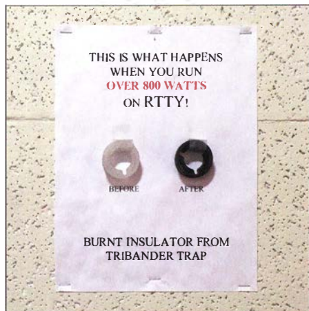
Bild 4: Ein Warnhinweis, den man zur Vermeidung von Antennenschäden unbedingt beachten sollte
