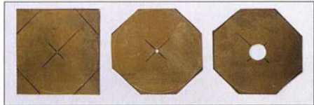
Bild 17: Ergebnisse der Bearbeitungsschritte von Strahler und Reflektor
