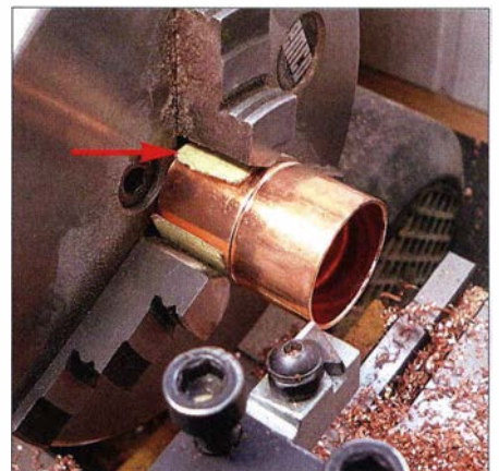
Bild 24: Ein Papierstreifen verhindert die Entstehung von Quetschmarken.
