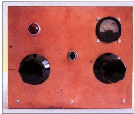
Bild 8: Frontansicht des nachgebauten Marconi-Empfängers; links Abstimmrehkondensator, rechts Potenziometer
