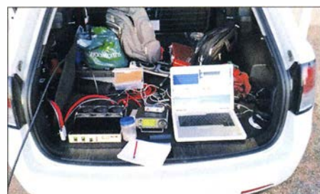
Blick in Waynes Kofferraum-Shack: von links PA, IC-706 und Laptop; die Ausrichtung der Antennen erfolgte rein manuell.
