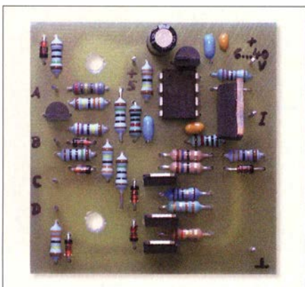
Bild 1: Leiterplatte der Konstantstromquelle für Stromstärken von 0,4 mA bis 0,2 A
