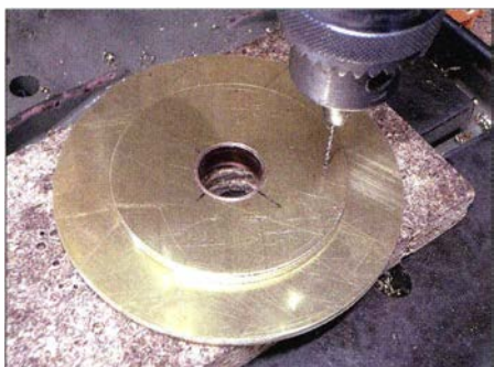
Bild 20: Bohrung für den SMA-Stift in die Scheiben von Strahler und Reflektor
