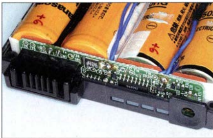
Bild 12: Leiterplatte in einem Notebook-Akku mit dem Schaltkreis BQ2092 zur Ladungsbilanzierung. Fotos: DJ3TZ
