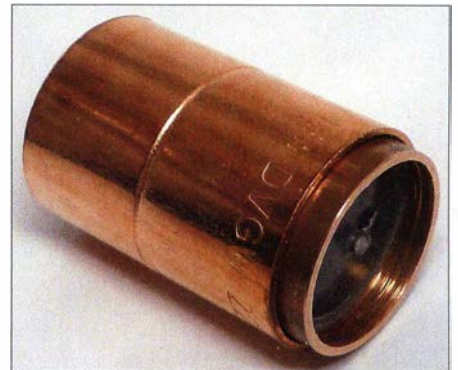
Bild 23: Der Kern verstärkt die Kupfermuffe an der Einspannstelle.
