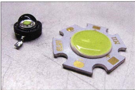
Bild 1: Links eine 1-W-LED mit einem Chip und rechts eine 3-W-LED mit sechs Chips
