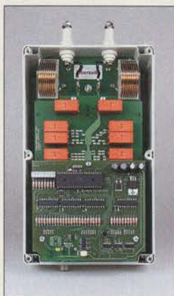
Antennenkoppler BX-1200 mit geöffnetem Gehäuse
