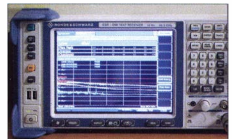
Messung des Störspektrums eines Schaltnetzteils am Spektralanalysator
