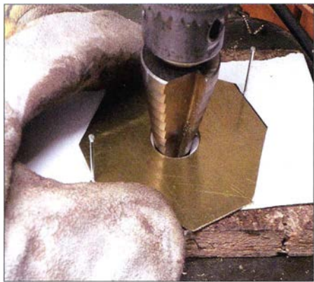
Bild 18: Das Bohren der 22-mm-Löcher muss unter Zugabe von Öl erfolgen.
