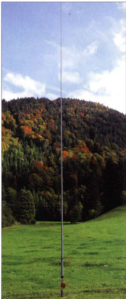
Bild 1: Die Befestigung der Vertikalantenne erfolgte hier am Pfahl einer Weide. Die Drahtumzäunung dient hier als Gegengewicht.
