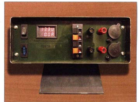
Bild 3: Selbst gebaute, universell verwendbare Stromversorgungseinheit FES10 für den rauen Portabeleinsatz im Gehäuse einer Transportkiste
