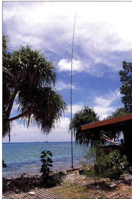
160-m- und 80-m-Vertikalantenne in der Nähe des Strands mit guten Abstrahlbedingungen Richtung Europa
