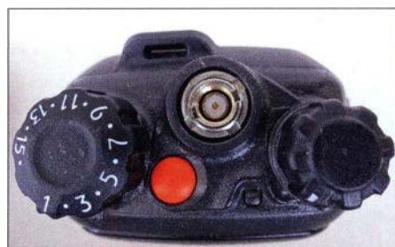
Über die Revers-SMA-Buchse lassen sich auch andere Antennen anschließen.
