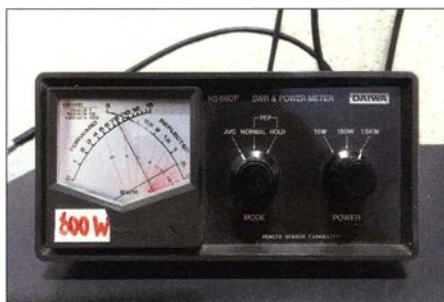
Bild 3: Maximal 800 W Ausgangsleistung, um die Traps in den Richtantennen zu schützen
