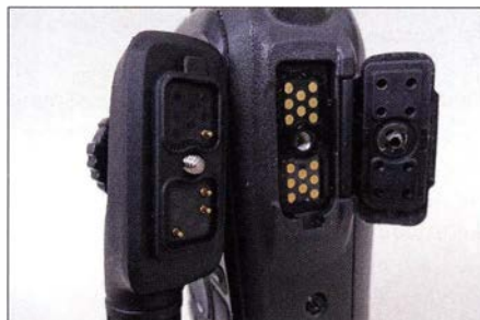
Anschluss für Programmieradapter oder externes Mikrofon
