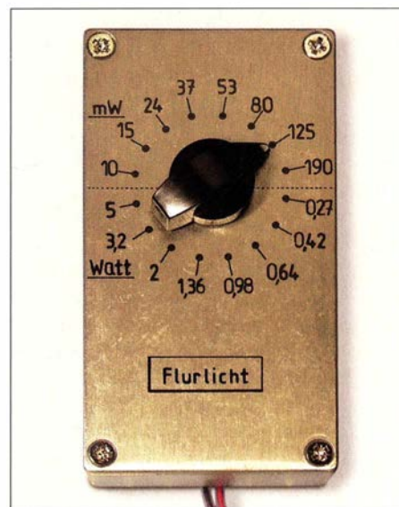
Bild 3: Die Leiterplatte in Bild 1 wurde hier für einen in 16 Helligkeitsstufen einstellbaren LED-Dimmer verwendet. Fotos: Franke
